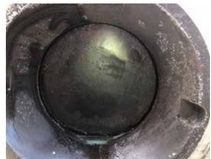
Efter 18 månader i drift utan problem visade ventilen inga tecken på slitage eller uppströms mediauppbyggnad.
